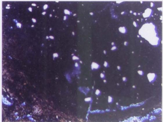
Abb. 133: Mauermörtel A21 (Rotunde), feine Calcitmatrix mit wenig Quarz. 13,5fache Vergrößerung.
