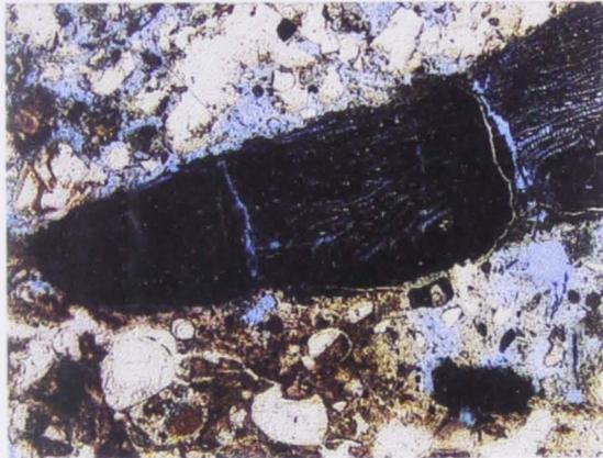
Abb. 129: Mauerbinder A3 (Rotunde), Holzkohlefragment in carbonatischer Matrix. 13,5fache Vergrößerung.
