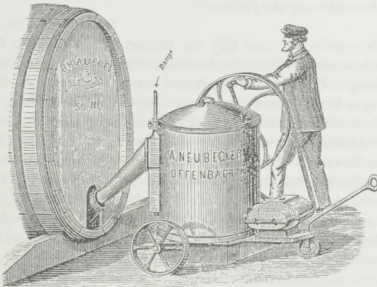
Abb. 18: Pichmaschine für Dampf und Gebläse kombiniert mit einer Düse um 1880
