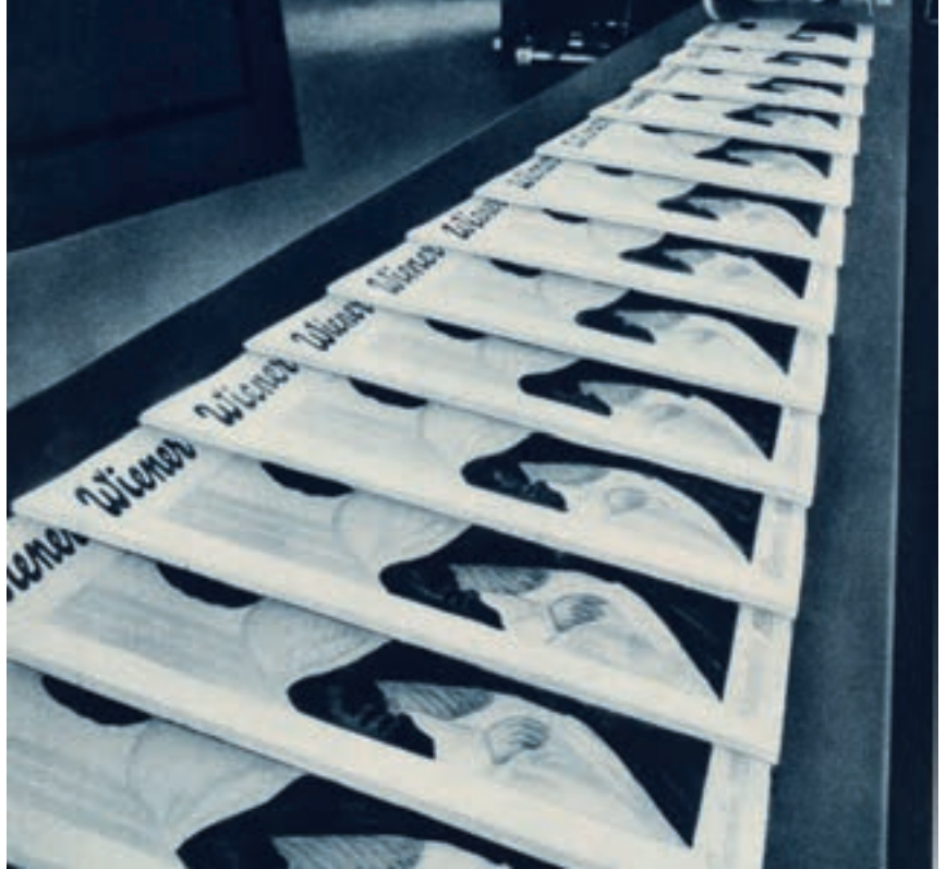
Abb. 9 „Wie das Wiener Magazin entsteht“. Die Zeitschrift verlässt gefalzt und geheftet die Rotationsdruckmaschine. Wiener Magazin , Heft 2, Februar 1932, Foto: Fotoagentur Polyphot.
