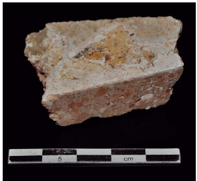
Abb. 4: Echantillon 07, peinture murale du mur sud du frigidarium . La surface de cet enduit permet d'observer la superposition de deux décors. Le premier, à fond jaune moucheté, sur un intonaco à cristaux de calcite, correspond déjà à une reprise du décor du mur sud de la salle froide
