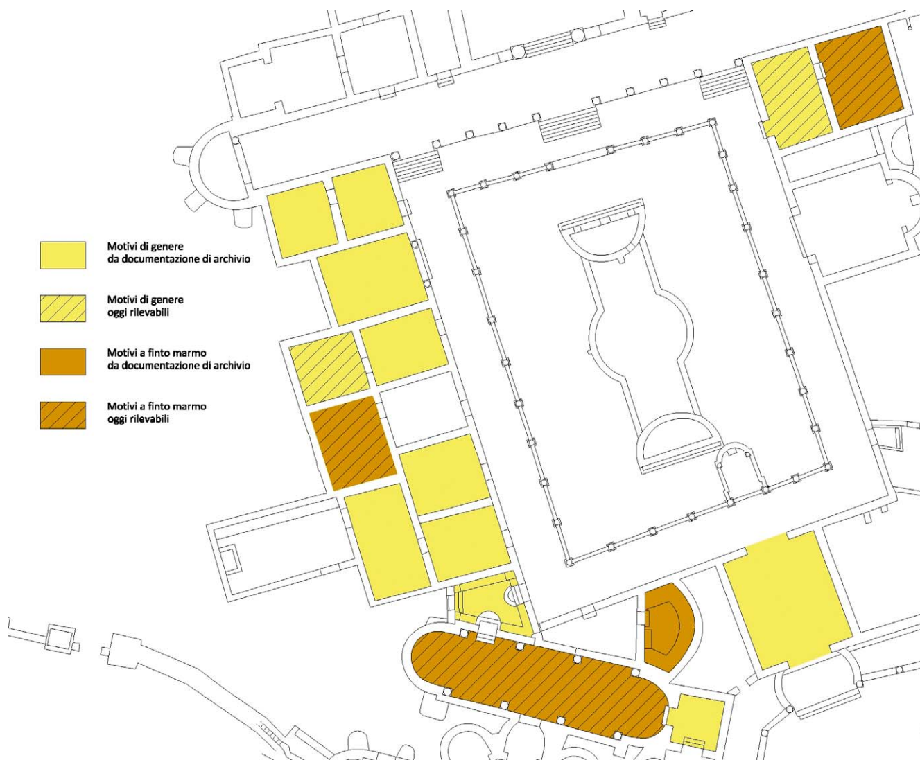
Abb. 5: Villa del Casale, settore del Peristilio, mappatura dei motivi pittorici e del loro stato di conservazione
